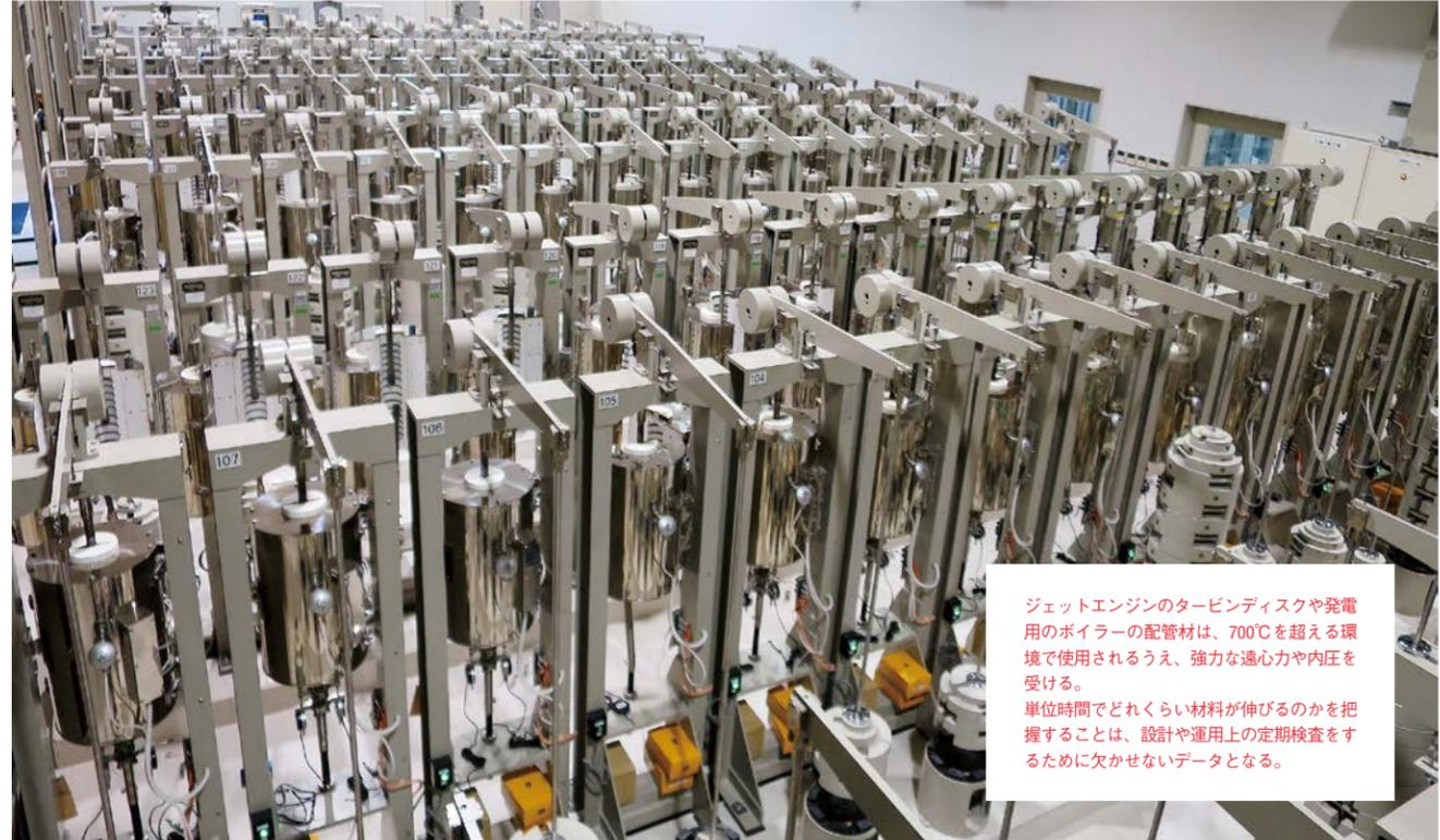
ジェットエンジンのタービンディスクや発電用のボイラーの配管材は、700℃を超える環境で使用されるうえ、強力な遠心力や内圧を受ける。単位時間でどれくらい材料が伸びるのかを把握することは、設計や運用上の定期検査をするために欠かせないデータとなる。
